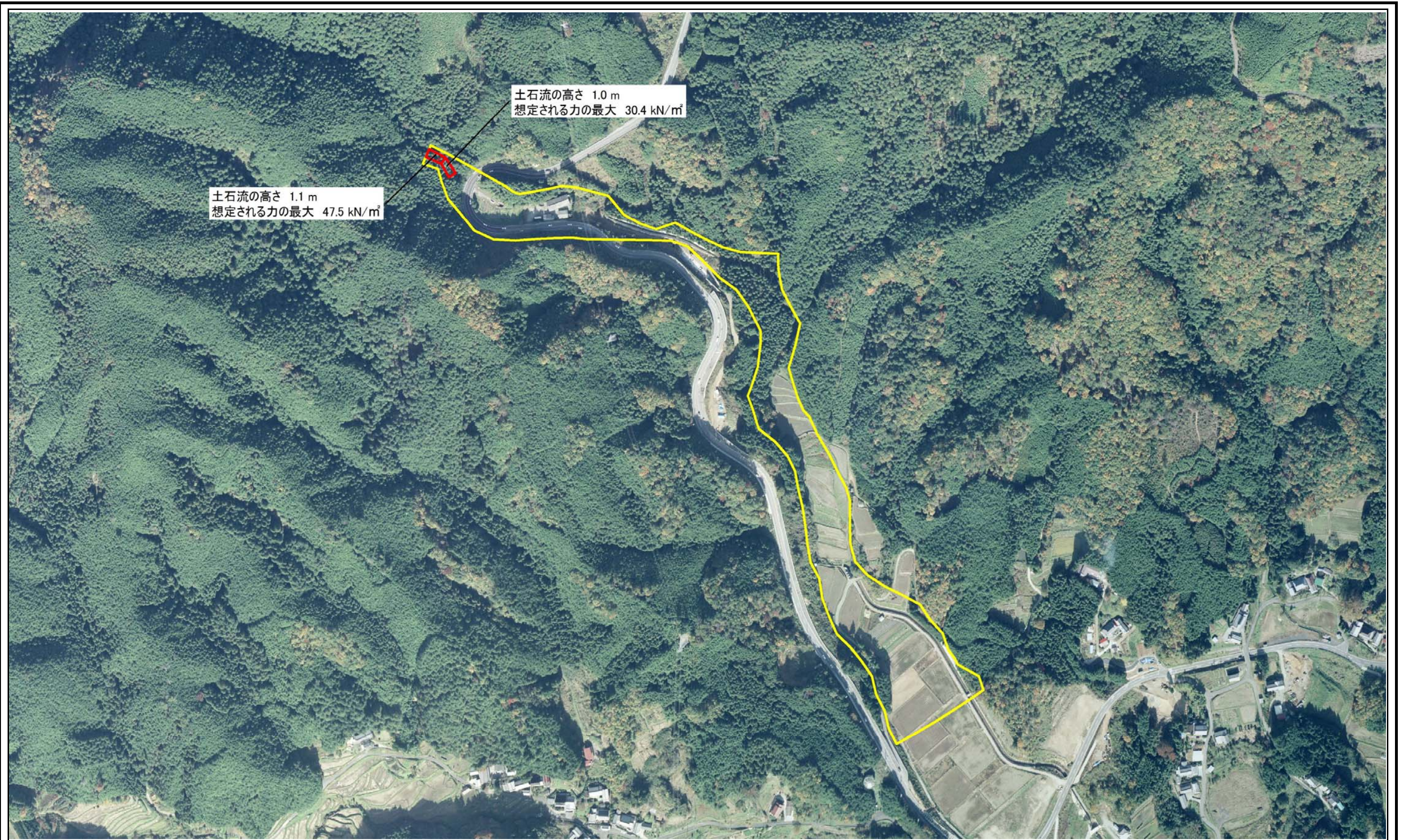
様式-2(土)(参考) 土砂災害警戒区域・土砂災害特別警戒区域 区域図
